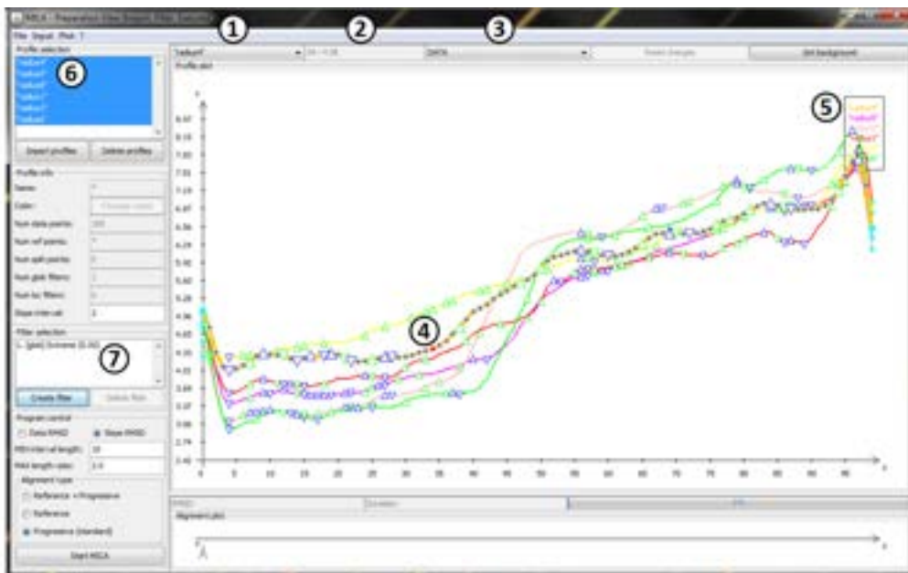
ABBILDUNG 4.8: Visualisierung der importierten Profile. (1) Auswahl des im Vordergrund stehenden Profils, (2) Eigenschaften des ausgewählten Punktes im Profil (siehe (4)), (5) Legende der dargestellten Profile, (6) Ausgewählte Profile für die Visualisierung, (7) Eintrag eines Filters.
