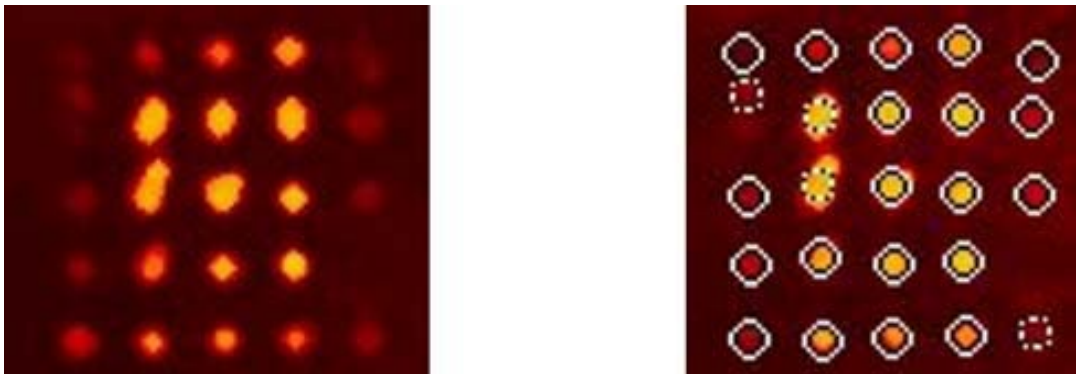
Abbildung 14: Ausschnitt einer Falschfarbendarstellung im Programm Signalyse™ während der Auswertung. Die automatische Lokalisierung der leuchtenden Punkte wird durch eine weiße Umrandung dargestellt. Unförmige oder fehlplatzierte Punkte werden in der Auswertung vernachlässigt und durch eine gestrichelte Umrandung gekennzeichnet (Bönisch, 2008).
